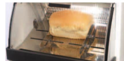
Le système breveté JAC rend encore plus conviviale la nouvelle génération de coupeuses Self Service. Lors de la sortie des couteaux, les tranches sont rassemblées et maintenues afin de faciliter l'extraction du pain de la machine.
