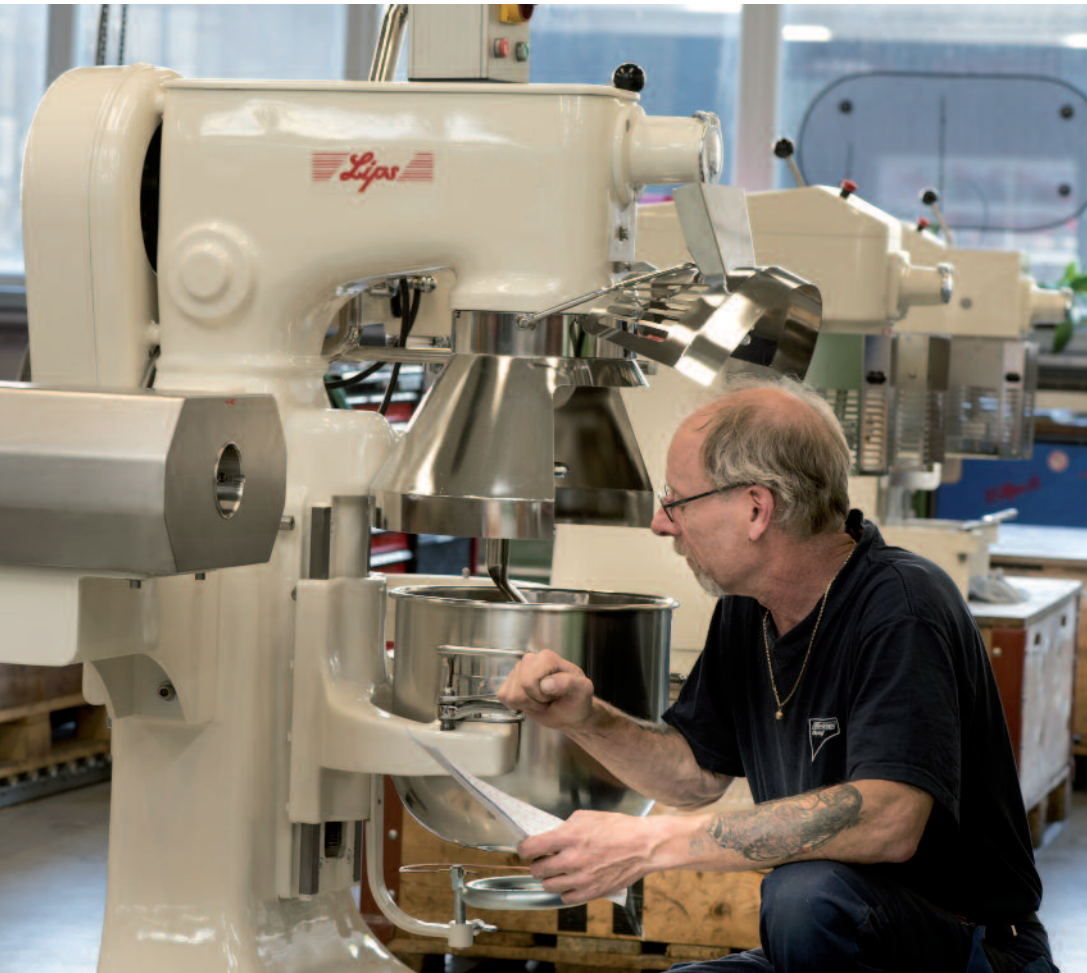
Nach dem Durchlaufen der verschiedenen Stationen der Werksrevision werden die Lips-Universalküchenmaschinen sicherheitstechnisch nachgerüstet und funktionell mit Feuma-Ansteckgeräten aufgewertet. Montagetechniker Charly Brötje bei der Endmontage.
