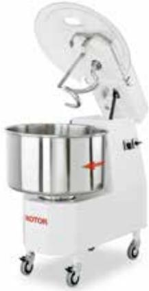
Eine interessante Variante sind die Spiralknetter mit aufklappbarem Kopf, welche eine vereinfachte Reinigung ermöglichen. Bei diesen Typen sind Kessel und Werkzeuge abnehmbar. Ein Flachrührer, der anstelle des Spiralknetters verwendet werden kann, ist bei allen aufklappbaren Maschinen im Lieferumfang enthalten. Es können mehrere Kessel eingesetzt werden.
