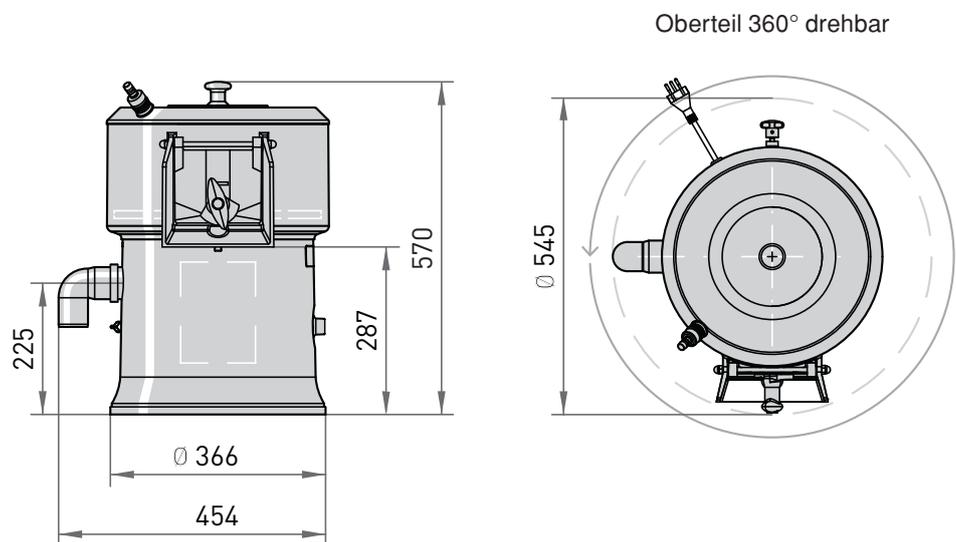
Tipp: die Position des Wasserauslaufes zur Auswurfklappe bei der Bestellung angeben, damit die Maschine bereits eingestellt geliefert wird.
